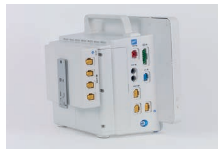
Life Scope E7 mit Multikonnektor-Erweiterungsmodul.
